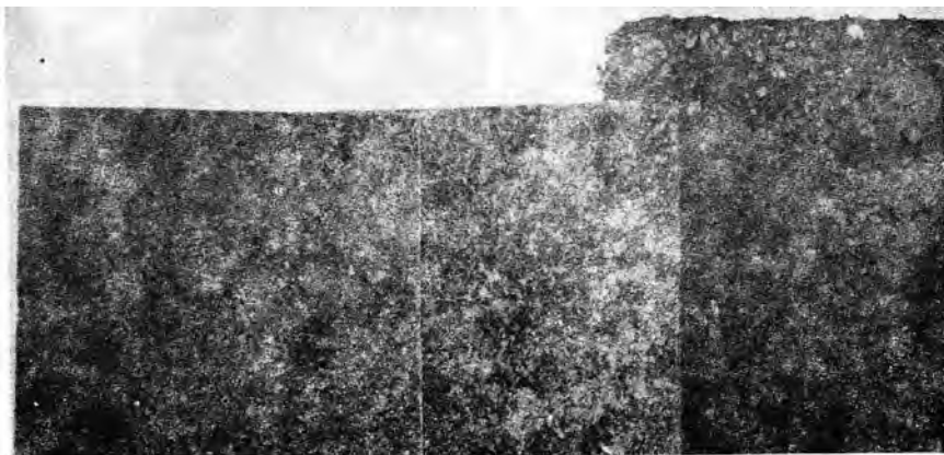
FIGURA 1. El primer tablero de izquierda a derecha representa la formulación con \text{Cl}_2\text{Ca} , el central, con \text{Cl}_2\text{Mg} , y el del extremo derecho, es el resultado obtenido con la utilización del binomio de aditivos \text{Al}_2(\text{SO}_4)_3 y \text{Na}_2\text{SiO}_3 .
