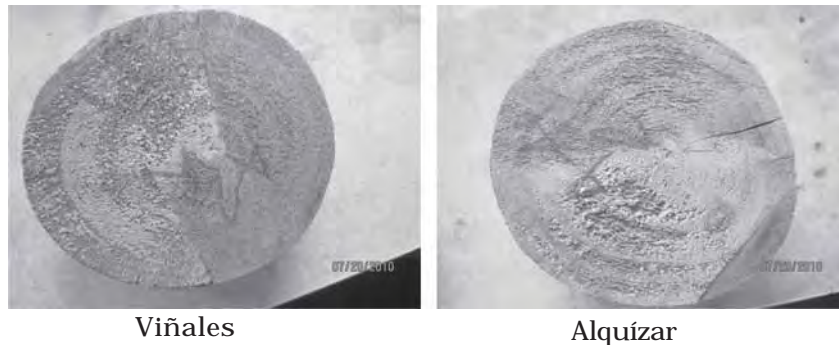
Figura 3. Comportamiento de la excentricidad de la madera.
