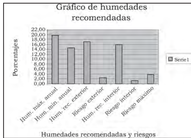
Figura. 1. Humedades recomendadas como promedios para el país y riesgo de cambios dimensionales.
