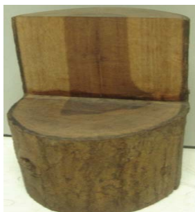
Figs. 4 y 5. Muestras de madera de sabicú y tengue respectivamente. Obsérvese diferencia entre albura y duramen.
