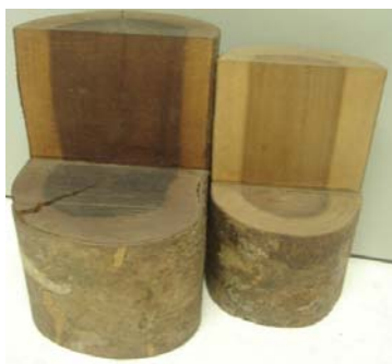
Figs. 4 y 5. Muestras de madera de sabicú y tengue respectivamente. Obsérvese diferencia entre albura y duramen.
