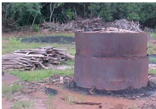
Fig. 4. Diseño del horno metálico para carbonización de residuos y carbonos obtenidos por este método.
