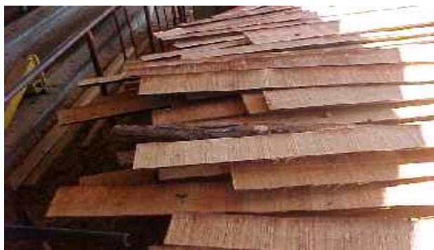
Fig. 2. Costaneras utilizadas en la fabricación de cajas.
