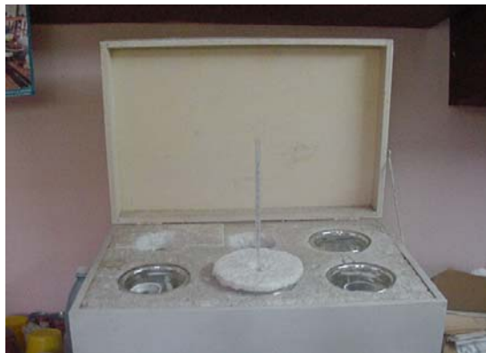
Fig. 1. Sistema adiabático para la medición de la temperatura de hidratación.
