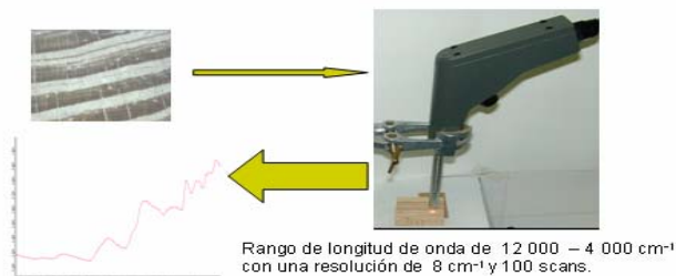
Figura 1 Método de evaluación no destructiva de la madera a partir de la Espectroscopia de Infrarrojo Próximo
